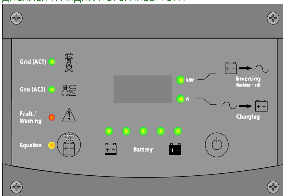
Дисплей и светодиодные индикаторы, расположенные на инверторе, позволяют определить текущее состояние работы инвертора.
