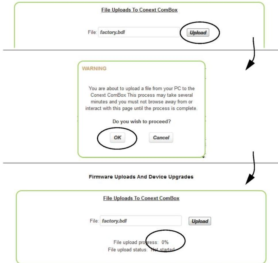
Когда пакет с файлами окончательно передан в Conext ComBox, файлы из пакета автоматически извлекаются, и начинается перепрограммирование Conext ComBox. Обновление Conext ComBox будет сопровождаться рядом экранов хода обновления, аналогичных тем, которые показаны на следующей странице.
