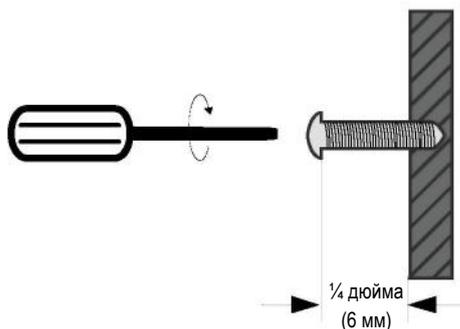
Винты и анкеры, входящие в комплектацию, не подходят для монтажа Conext ComBox на бетонную стену. Используйте два монтажных винта, эквивалентных винтам № 6.
