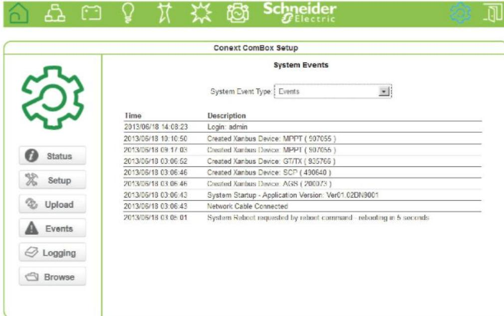
События перечисляются в хронологической последовательности. Для просмотра перечня использовать полосу прокрутки.
