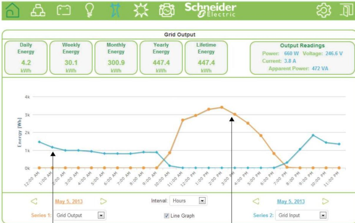
**Наблюдение № 1:** система получает электроэнергию из энергосети.
