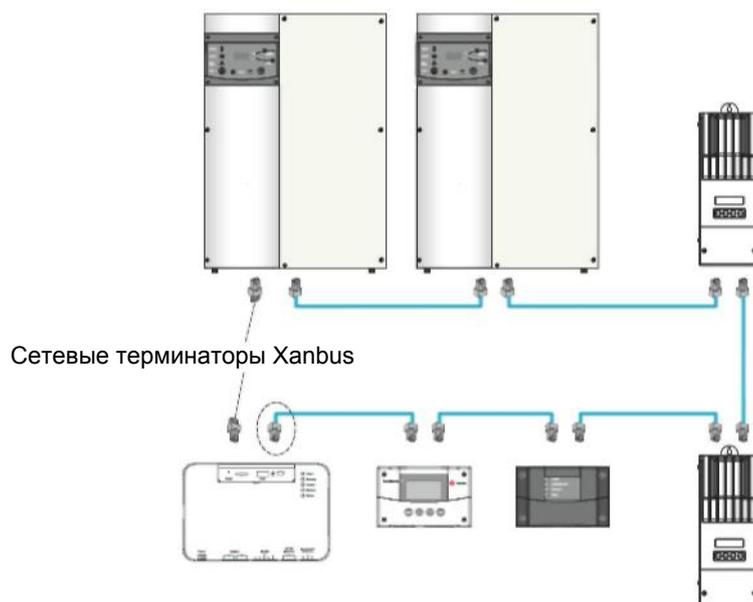
Обеспечьте наличие сетевых терминаторов Ханбус в сети Ханбус по обоим концам.
