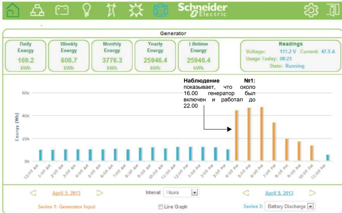
**Важно:** эта диаграмма основана на процессе зарядки, который базируется на применении дизельного генератора, и приводится только для иллюстрации. Различные системы работают по-разному, и приведенная выше диаграмма может не быть типичной.
