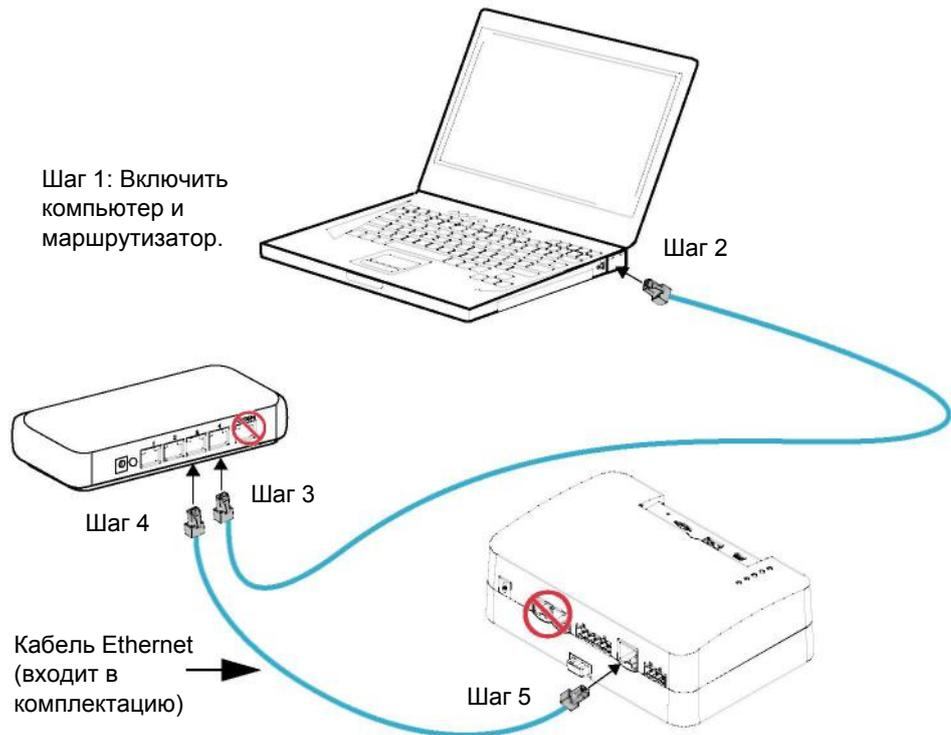
4. Один конец кабеля Ethernet (входящего в объем поставки )подключите к свободному порту LAN на сетевом маршрутизаторе.
