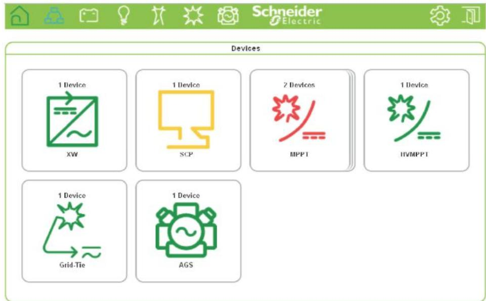
2. Щелкнуть кнопкой мыши по устройству, показывающему отказ или предупредительный сигнал, которое требуется обследовать. В данном примере щелкнуть MPPT с отказом (красный), чтобы открыть Device Summary Table (Сводная таблицу устройства) SCP (Панель управления системой).
