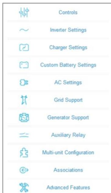
**Важно:** настройки устройства для каждого устройства Xanbus различны. Настройки, показанные здесь, применяются в инверторе XW. Прежде чем пытаться изменить настройки через Copext ComBox, необходимо обратиться к Руководству пользователя устройством.
