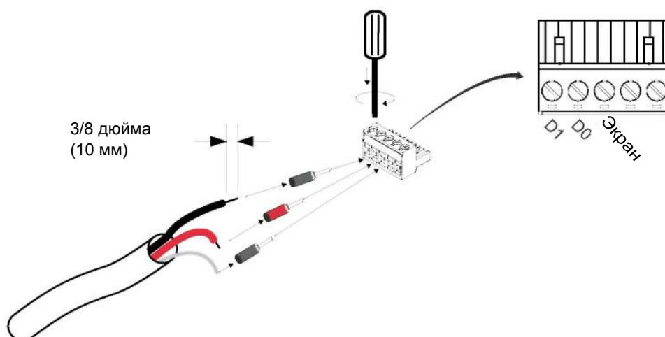
4. Зафиксируйте провода, затянув винт на выводе. Средний вывод остается незадействованным. Он выделен под экранированное кабельное подключение.
