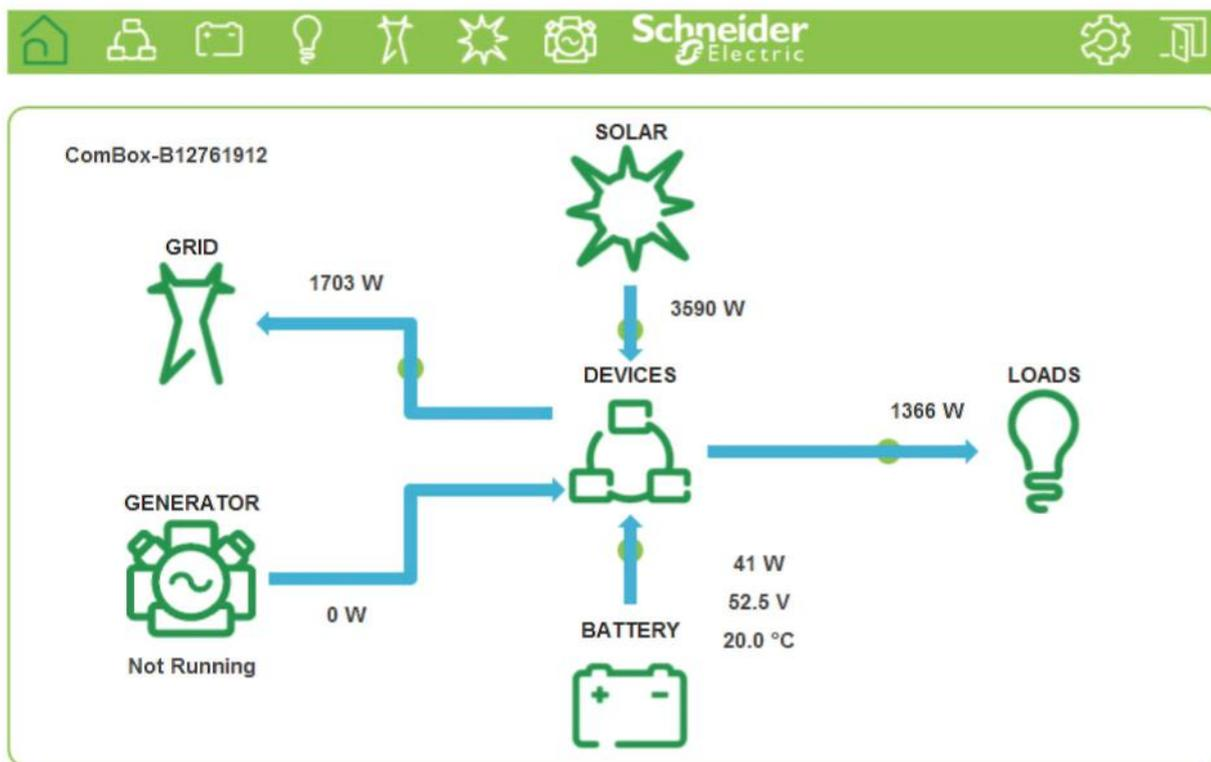
Рисунок 3-1 Главный экран (или экран схемы системы)
