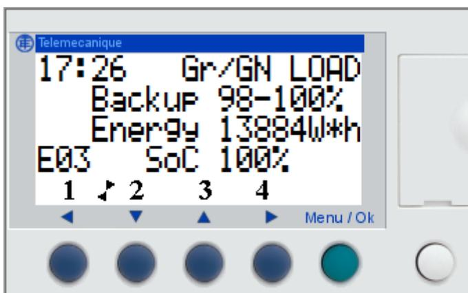
Контроллер имеет монохромный четырёхстрочный буквенно-цифровой дисплей. Подсветка дисплея включается при нажатии любой из расположенных под дисплеем кнопок.
