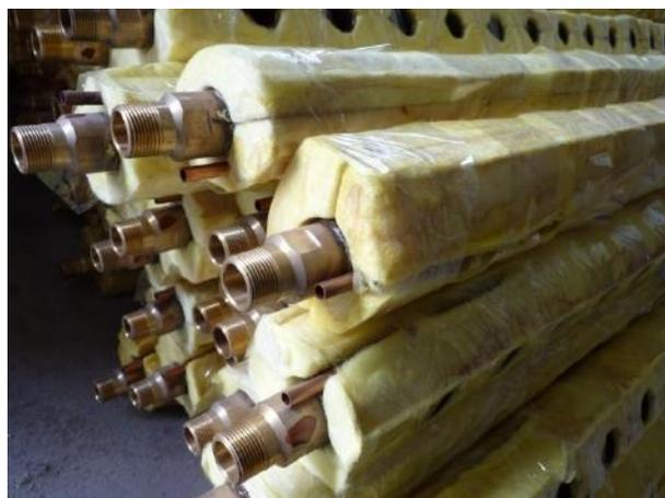
Утепление минеральной ватой до 75 мм.
